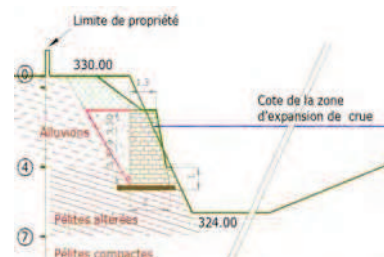
Impact enrochement de berge
